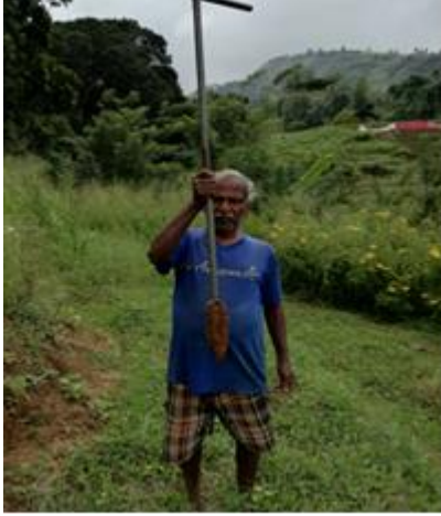
ඡායාරූප අංක 33 - පස් පරීක්ෂා කිරීම සඳහා සාම්පල ලබා ගැනීම - දෙල්තොට පූකෙට්ටු. 33 - මණ් පාරිශොතනෙක්කාක මණ් මාතිරිකනෙ පෙහල් - தெல்தோட்டை Photo No. 33: Taking samples for soil testing - Delthota
